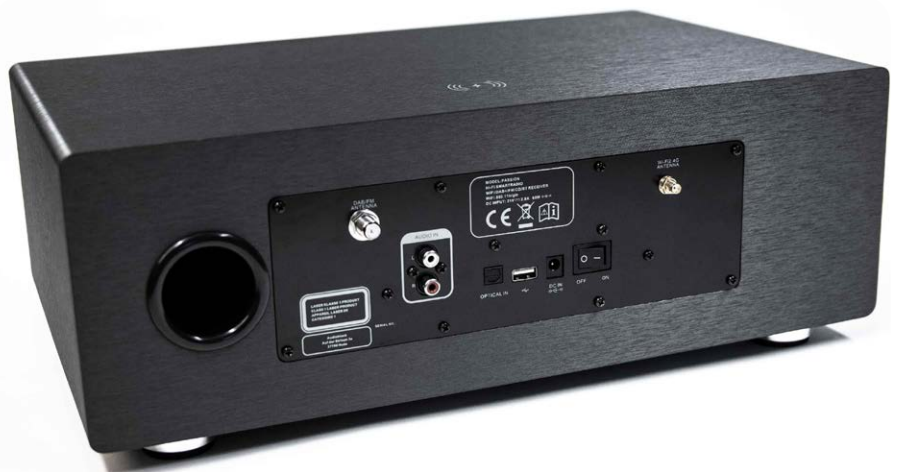
Auf der Rückseite befinden sich ein analoger und digitaler Audioeingang. Zudem können hier USB-Sticks und USB-Festplatten angeschlossen werden (Foto: Block)
